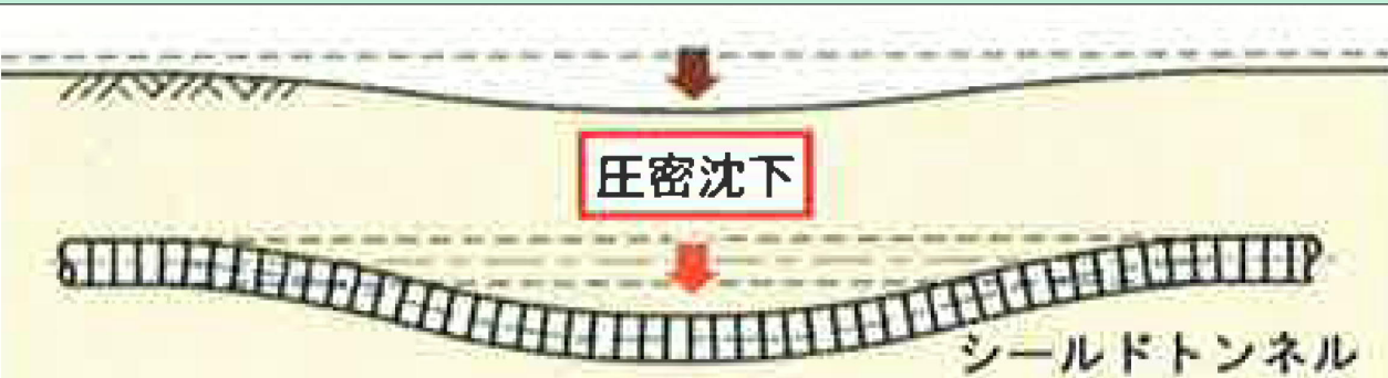
圧密沈下に伴うシールドトンネルの沈下
