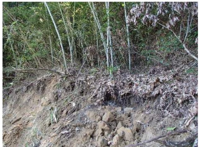
写真-1.6 崩壊箇所頭部の状況
