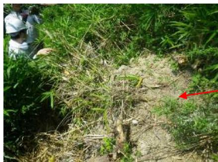
斜面下部（遷緩線付近）における圧縮変位を示唆する土砂の押し出し（隆起し、植生が前面に転倒）を確認。
